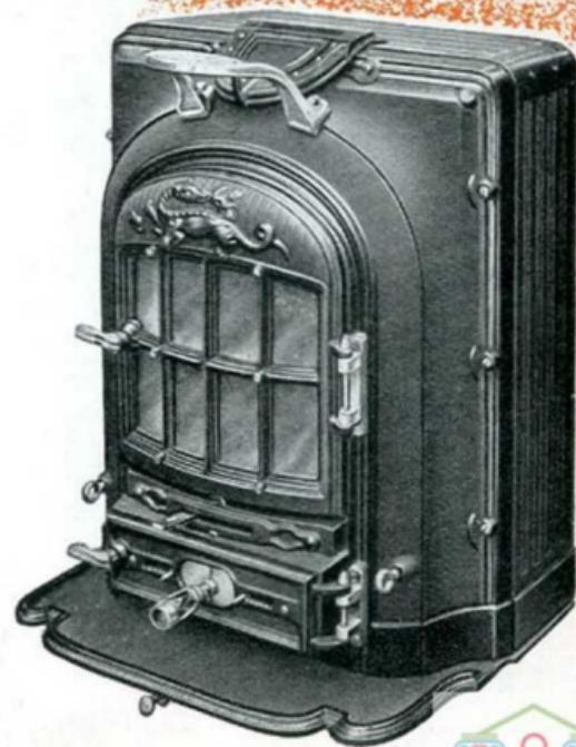
C'est notre modèle Kritos approfondi, grâce à un entourage en fonte qui sépare la façade du dos, d'où résultent une plus grosse réserve de combustible et une plus grande surface de grilles, lui donnant une surpuissance telle qu'il soit à même de chauffer 225 à 300 mètres cubes avec une consommation moyenne de 16 à 18 kgs par jour.
